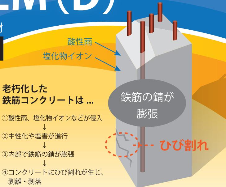
二つの含浸材が 鉄筋(内部)・コンクリート(表面)を保護！
