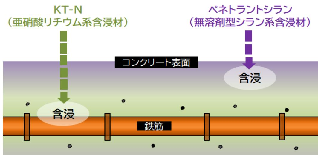
KT-N (亜硝酸リチウム系防錆含浸材) + ペネトラントシラン (無溶剤型シラン系含浸材)
